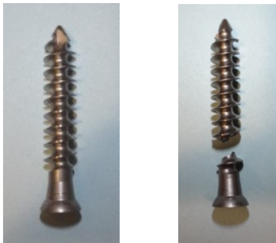
Intakt 35 mm skrue (v.) og fraktureret 35 mm skrue (h.)
