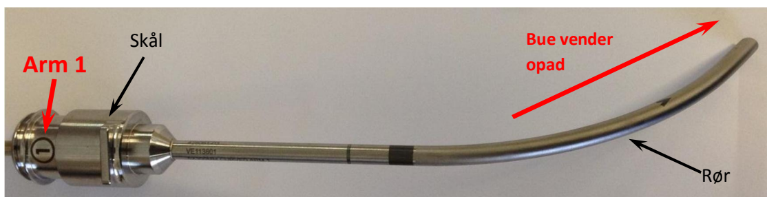
Figur 1 - Rigtig retning - kanyle arm 1: Bue vender opad
