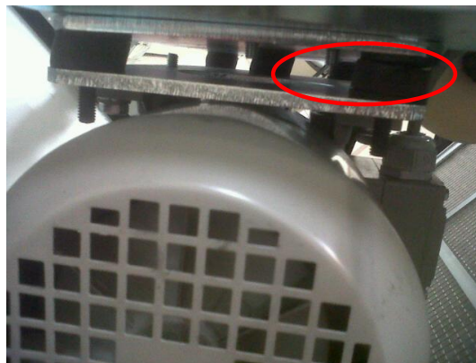
Fig. 1: Eksempel på nedbrudt gummidæmper på monteringsplade
