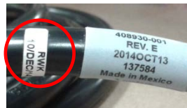
Figur 2 Korrekt strømkabel inden for datointervallet med RWK-mærkat
