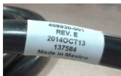
Figur 1 Ukorrekt strømkabel falder inden for datointervallet
