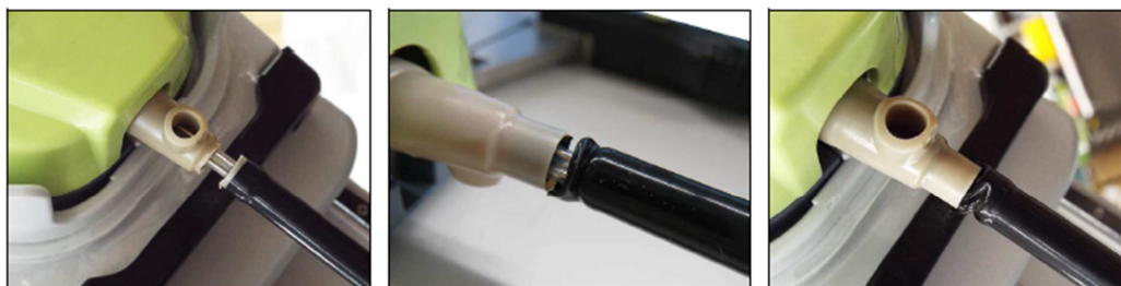
Figur 2. Eksempler på brud ved tandhjulets og instrumentskaftets forbindelsespunkt
