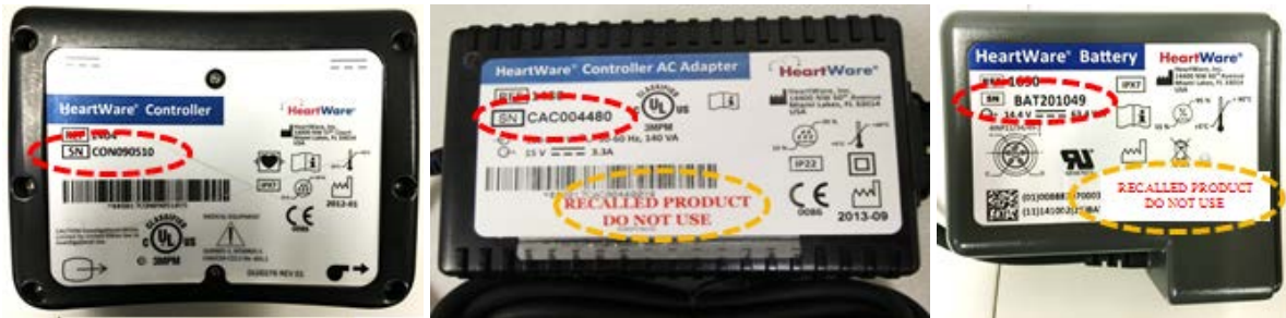
Bemærk produktserienumrene med rød cirkel (fra venstre mod højre: controller, AC-adapter, batteri). Fastgørelsessted for tilbagekaldelsesmærkat med gul cirkel (intet mærkat nødvendigt på controlleren).
