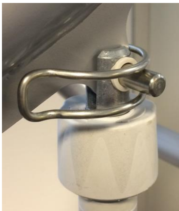
Figur 7. Monteret låsestift i den rigtige størrelse. Bøsningen skal monteres korrekt på øjet på stempelstangen, og låsestiftens hoved skal stikke ud gennem den sammenklappede aksel
