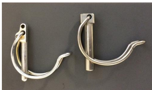
Figur 3. Forkert størrelse låsestift (venstre) og korrekt størrelse låsestift (højre)
