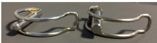
Figur 4. Forkert størrelse låsestift med diameter 7,5 mm (venstre) og korrekt størrelse låsestift med diameter 10 mm (højre)
