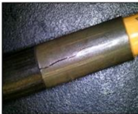
Figur 2. Eksempel på revner fundet på beskadigede MCS-instrumenter
