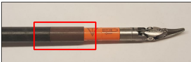
Figur 1. da Vinci S/Si EndoWrist MCS med den proximale kant af forlængerrøret fremhævet.
