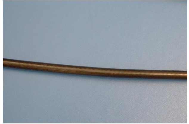
Figur 6: Ubeskadiget og intakt motorkabel
