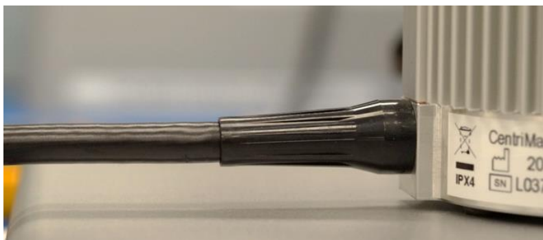
Figur 4: Kablets bøjningsbeskyttelse ved motoren
