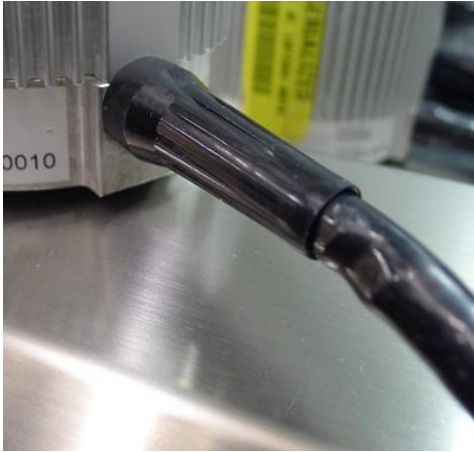
Figur 5: Kabelbeskadigelse ved motorens bøjningsbeskyttelse motorkabel
