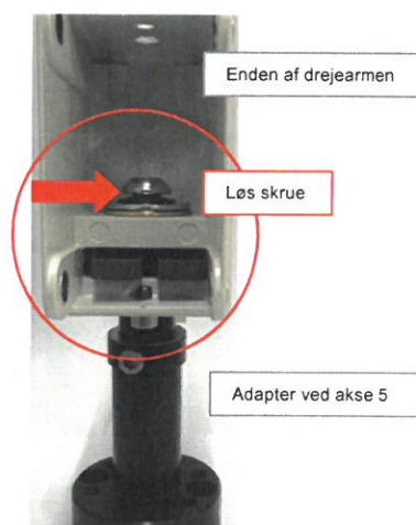
Figur 2: Løs skrueforbindelse mellem drejearmen og optikholderen
