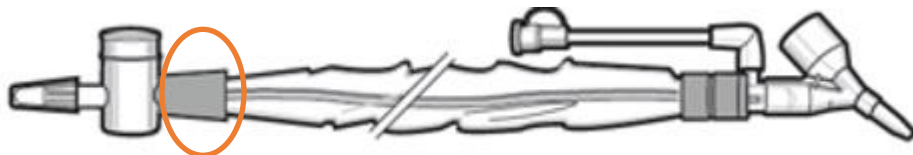
Figur 1: Stedet hvor den potentielle okklusion blev identificeret. Blokeringen er ikke synlig for brugeren.
