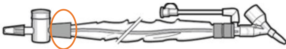
Figur 2: Stedet hvor den potentielle okklusion blev identificeret. Blokeringen er ikke synlig for brugeren.
