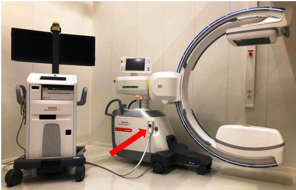
figur 1: eksempel på X10-stik med hovedkabel, tilsluttet Cios Spin c-bue
