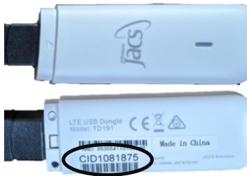
Figur 1. Mobiladapter af typen 4G LATITUDE MIMIC set forfra/bagfra – serienummeret fremgår af CID-mærkatet.
