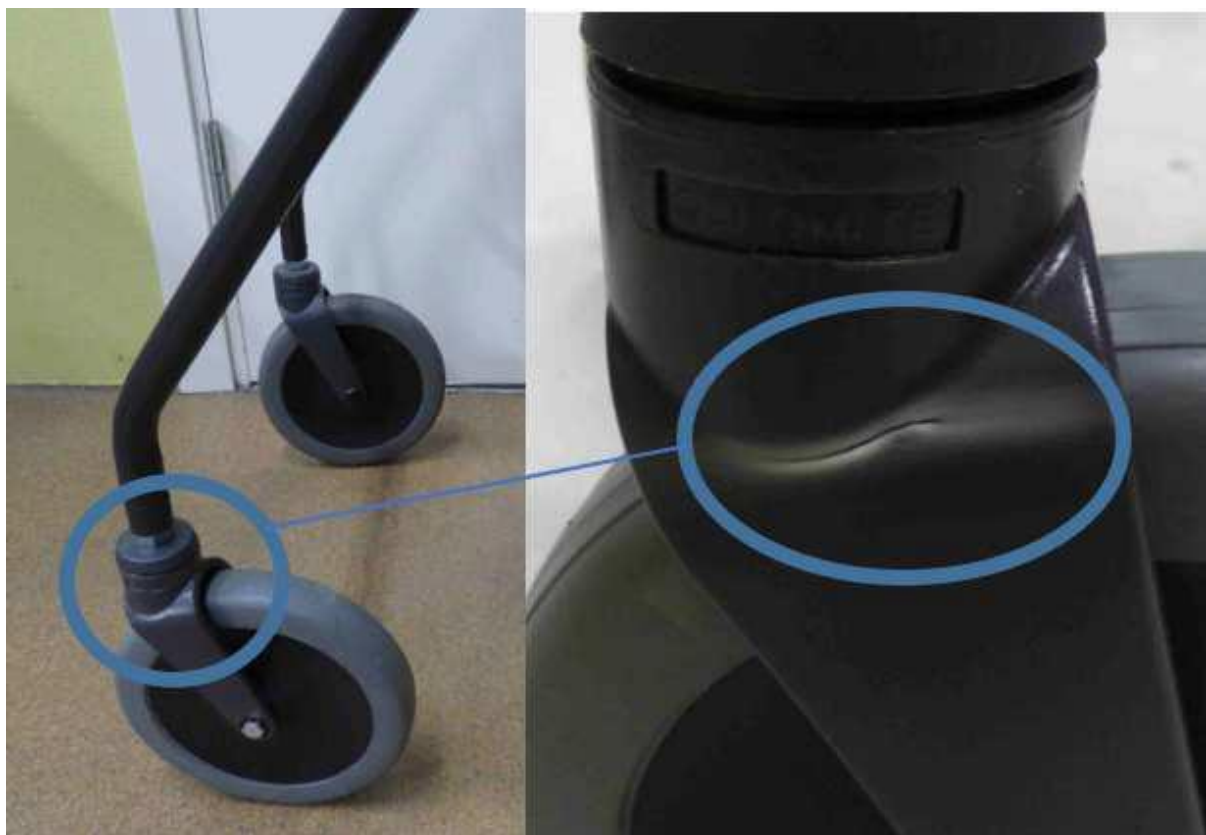
Fig 1: Et tegn på en begyndende defekt/skade på venstre forgaffel. Der ses en lysere farve ved det begyndende brud
