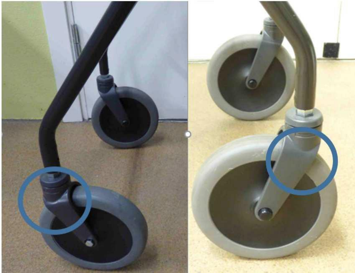
Fig 2: På billedet til venstre er et begyndende brud og på billedet til højre er en fejlfri forgaffel
