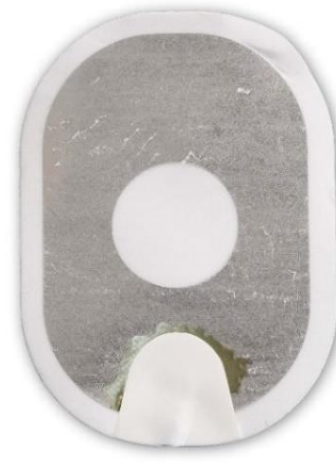
Figur 3: Gel næsten helt adskilt fra bagbeklædningen.
