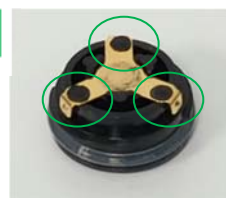
Ubeskadigede batterilåg - fortsæt til brug Har tre løftede, runde, sorte, plastikpunkter, som holder metalkontakten på plads
