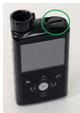
Batterilåget findes på toppen af pumpen, hvor AA-batterirummet er placeret
