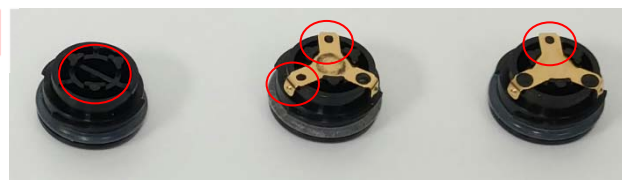
Beskadigede batterilåg - må ikke anvendes Metalkontakt mangler eller færre end 3 hævede punkter kan ses
