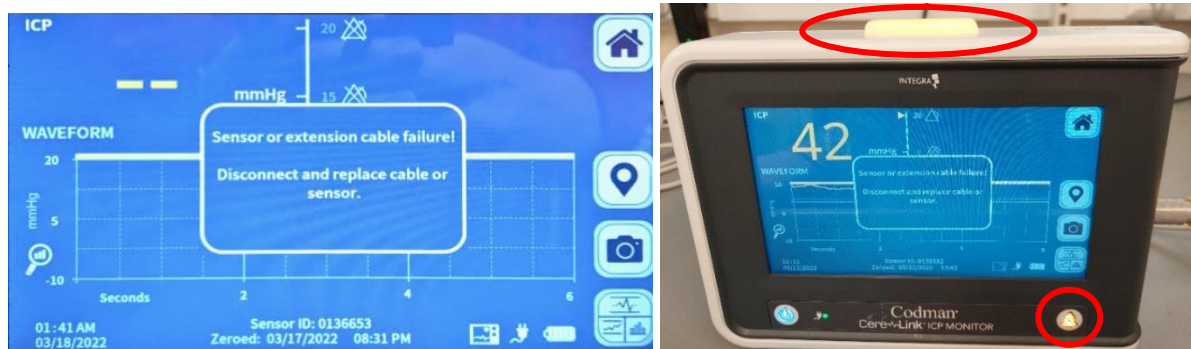
Figurer 1 (venstre) og 2 (højre): Visuelle alarmer inklusive display og blinklysalarm
