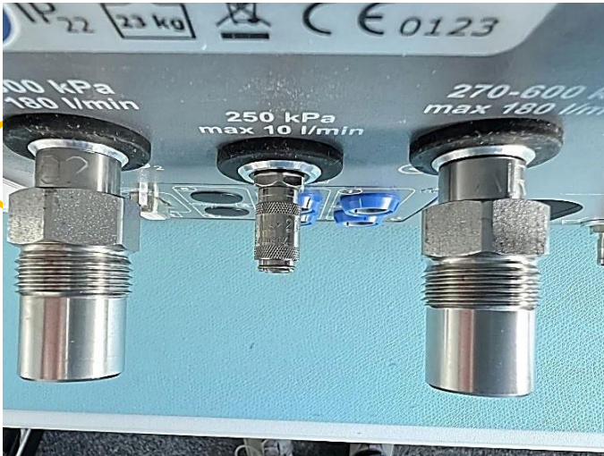
Figur 2: Visning af kodningen til kontrol af NIST-forbindelserne.
