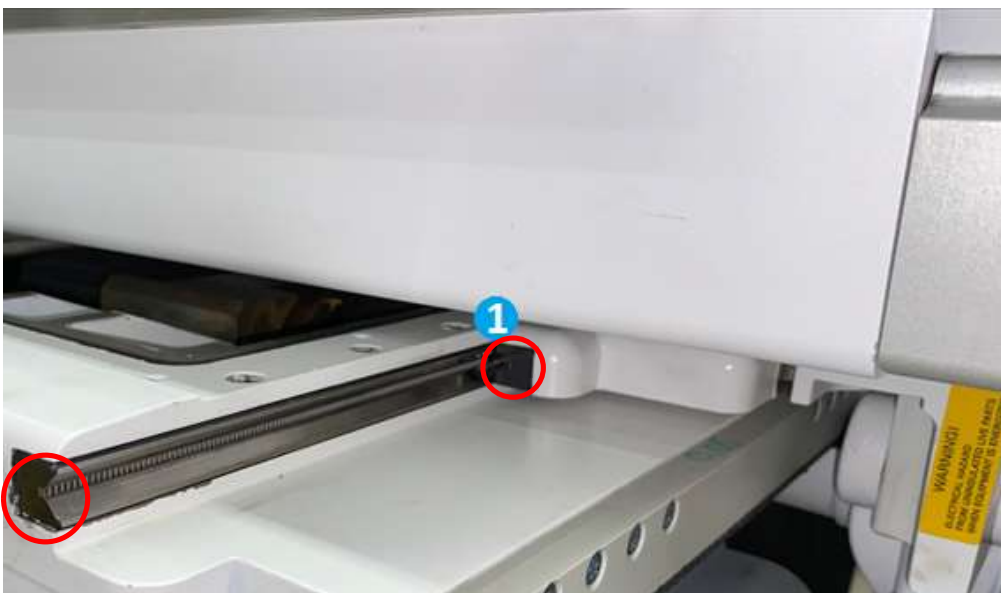
Billede 2: Korrekt placeret rulleleje med plan overflade til enden af styreskinnen (1)
