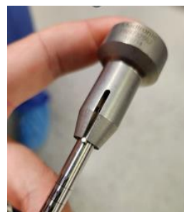
Figur 1. Identificering af tværstift på perkutan stift (venstre) og problem med pasform med taphætten (højre)
