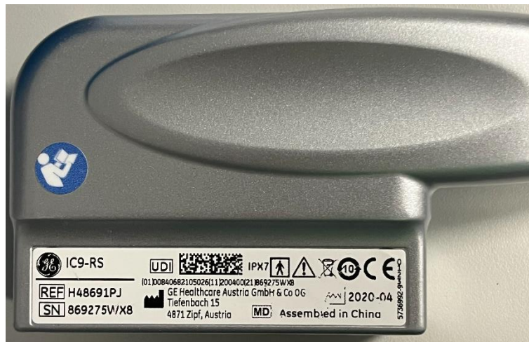
Figur 4. Eksempel på mærkeplade – visning af probetype (IC9-RS) og serienummer (SN).
