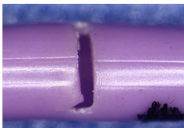
Figur 1: Eksempel på tværgående og omkredsmæssig revne i kateterlegemet
