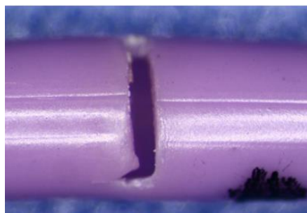
Figur 1: Eksempel på tværgående/perifer revne i kateterslangen
