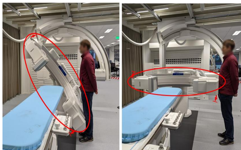
Figur 3: Uregelmæssige bevægelser af C-armen (rød cirkel) på grund af en knækket spændebolt til propel motoren.
