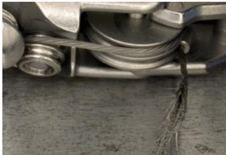
Figur C: 20x forstørrelse af et knækket grebskabel på et da Vinci Xi-instrument.
