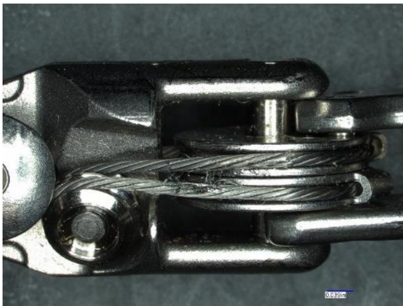
Figur D: 20x forstørrelse af et flosset grebskabel på et da Vinci Xi-instrument
