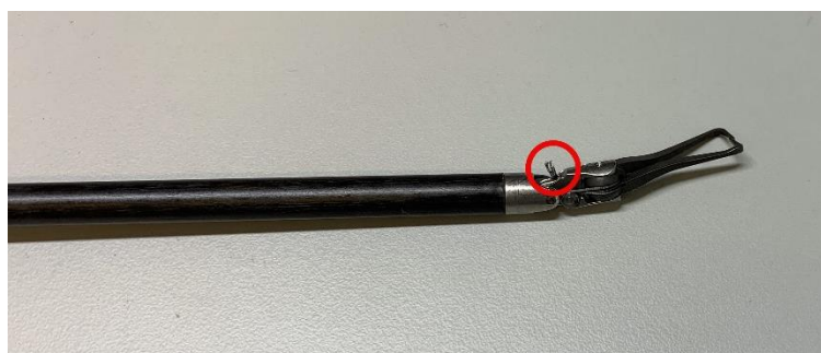
Figur F: Knækket pitch-kabel
