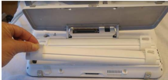
Figur 3-6. Udskiftning af et batteri
