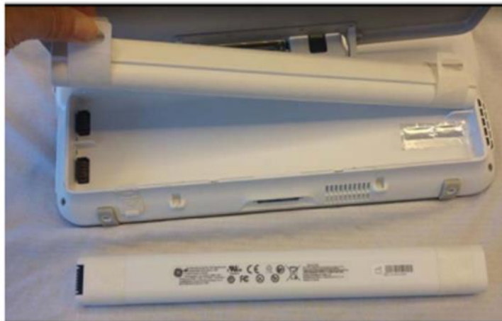
Figur 3-7. Fjernelse af det andet batteri
