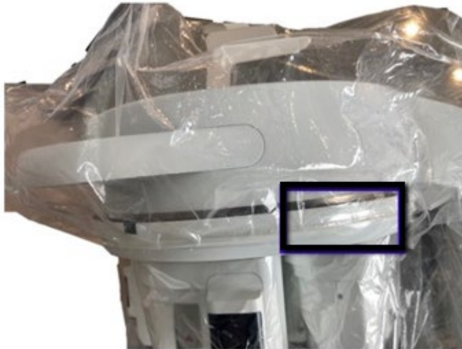
Figur 2: Afdækningen er korrekt monteret, og instrumentarmens sølvfarvede del er skjult.
