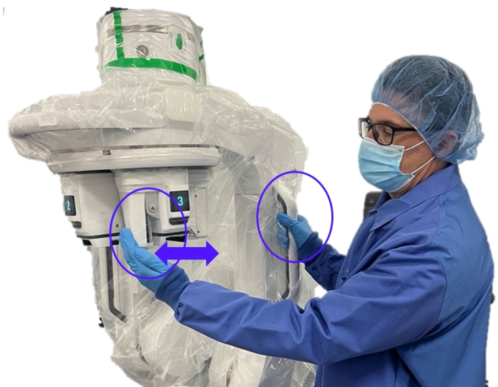
Figur 5: Sådan kan instrumentdrevet drejes
