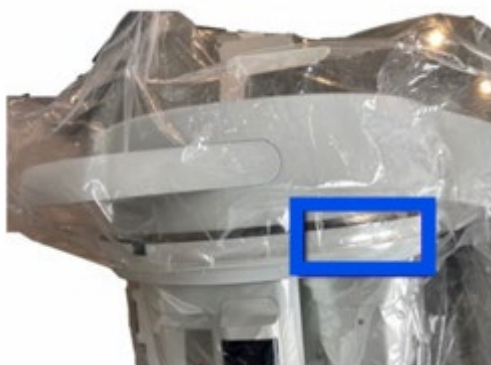
Figur 6a Korrekt: sølvfarvet del skjult
