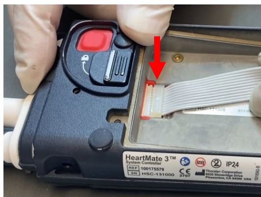
Figur 1: Tilslutning af reservebatteriets båndkabel
