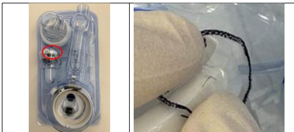
Figur 1. Placering af defekt på bakke og eksempel på revne
