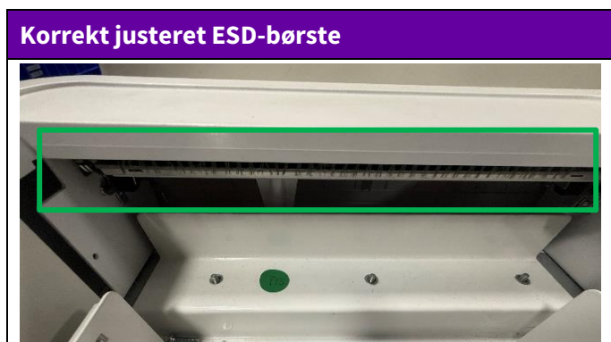
Figur 1: Korrekt justeret ESD-børste
